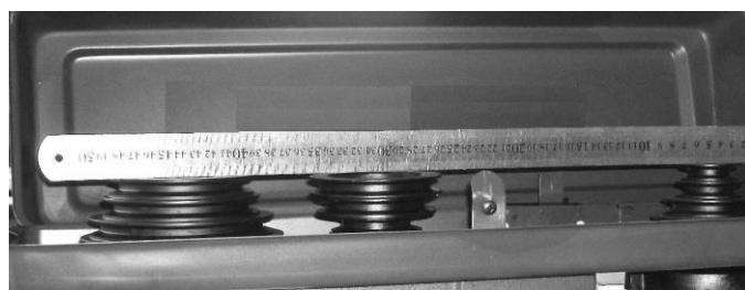
руйте высоту шкивов. Шкив шпинделя (база) не регулируется. Промежуточный шкив регулируется при помощи компенсирующих шайб. Регулировка шкива электродвигателя производится перемещением электродвигателя по площадке, на которой он установлен (рис.10).
