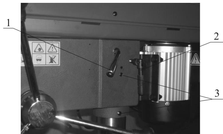
Правильное натяжение клиновых ремней обеспечивает их долговечность. После выбора скорости вращения шпинделя и установки клиновых ремней нужно нажать на рычаг натяжения ремней 1. Натянуть ремни, и зафиксировать положение двигателя зажимной ручкой 2. Натяжение клиновидного ремня должно быть таким, чтобы после нажатия на ремень между шкивами с усилием 2кг он прогибался на 1 см. (см. рис.).
