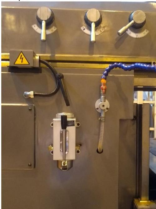
*Рис. 17 Насос смазки стола*
