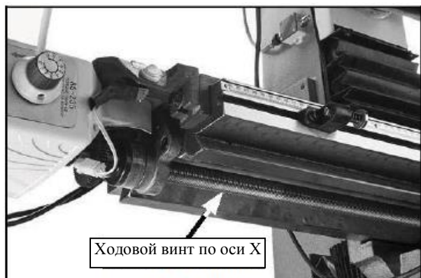
Рисунок 31. Ходовой винт для перемещения по оси X.
