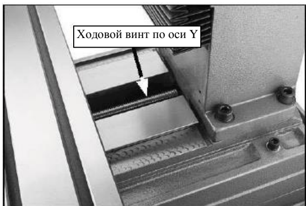
Рисунок 32. Ходовой винт для перемещения по оси Y.
