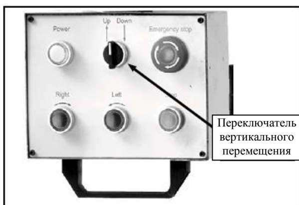
Рисунок 11. Переключатель вертикального перемещения для управления автоматическим ходом шпиндельной бабки.
